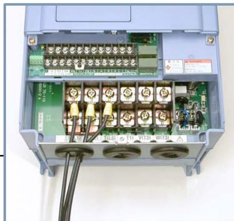
**NOTA:** El ejemplo de la derecha muestra un inverter L300P-110LFU2. La ubicación de terminales variará con cada modelo, (ver abajo). Notar que se emplean terminales cerrados por seguridad.
