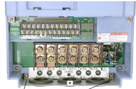
Tornillos retención de la placa metálica
