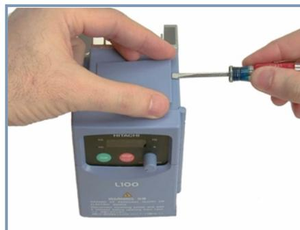
La cubierta superior está fijada por 4 cierres rápidos. Quitar esta cubierta, haciendo presión sobre las esquinas y empujar hacia arriba. Colocar el destornillador en una esquina y pulsar hacia arriba. No hacer fuerza de forma tal que se dañe la protección del enrejado plástico del Inverter.
