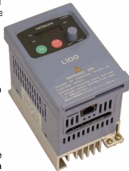
2. **Segundo nivel de acceso** - Ubicar el acceso a la apertura del panel abajo a la derecha cerca de los mensajes de seguridad. Tirar de esta esquina y abrir la media puerta. Esto deja expuestos 4 botones más del Inverter. Las FUNC., ▲, ▼, y STR permite el acceso al cambio de los parámetros del inverter. Los 15 terminales en dos niveles permiten controlar el Inverter a través señales lógicas. Estas señales son generalmente de baja tensión y corresponde a un segundo nivel de acceso.
