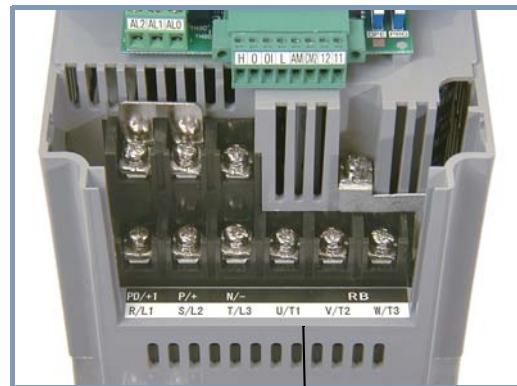
Terminales de alimentación y al motor
