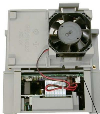
Conector PWB para los ventiladores
