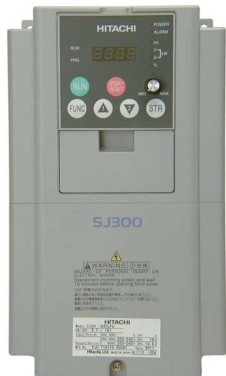
2. **Segundo nivel de acceso** - Primero, asegúrese que el equipo no está alimentado. Si ha sido previamente alimentado, espere al menos 5 minutos luego de cortar la alimentación y verifique que la lámpara de carga se haya apagado antes de proceder. Localizar luego el tornillo de retención en la parte inferior del panel. Usar un pequeño destornillador Phillips para quitar este tornillo. Presionar las dos áreas marcadas en el panel como se muestra al lado y deslizar la cubierta hacia abajo.
