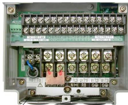
Tornillos retención de la placa metálica
