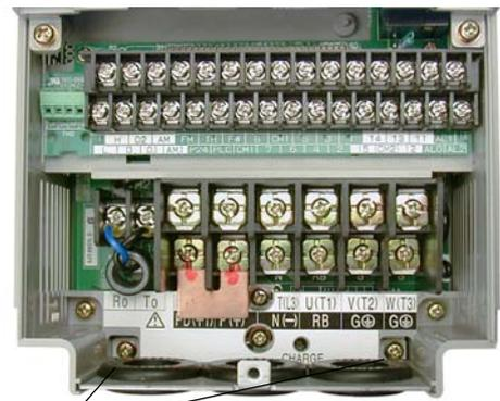
Parafusos retenção da placa metálica
