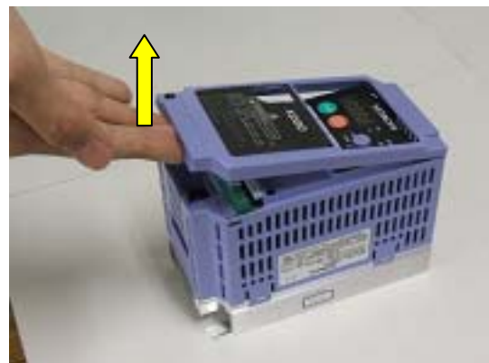
2. Levantar la cubierta, parte inferior
