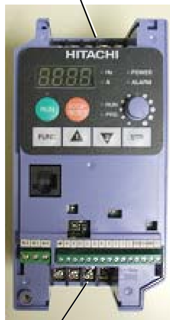
Terminales de Conexión al Motor y de conexión a opcionales, tales como (Choque de CC, Unidad de Frenado)
